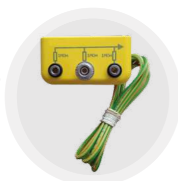
Соединительная колодка пластик (3 кнопки 10 мм, 3 резистора 1Мом + 1 наконечник под M5, 2м)
